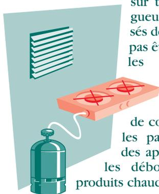
**10-** Les bouteilles, les tuyaux souples et flexibles ne doivent jamais être placés à proximité ou sous le rayonnement d'une source de chaleur susceptible de les porter à une température dépassant 50° C.
