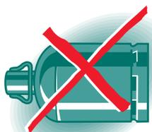
**1-** Une bouteille de butane ou de propane ne doit jamais être utilisée couchée mais toujours debout sur son fond et en position stable.
