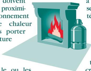
**11-** Après chaque utilisation, fermer le ou les robinet(s) des appareils alimentés puis celui de la bouteille. Avant de débrancher une bouteille, il faut toujours s'assurer que son robinet est bien fermé et qu'il n'y a pas de foyer allumé à proximité.
